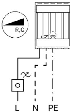
**DE** Anschlusssschema für DALI-Betrieb (DT6/DT8),
