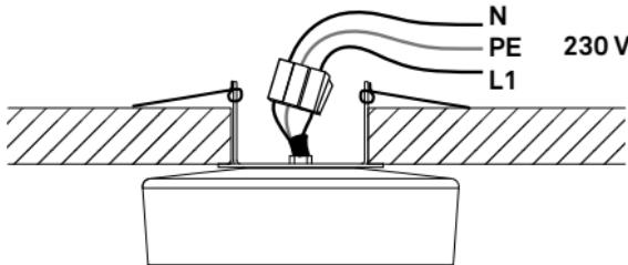
**DE** Anschlussschema 230V / AC **FR** Schéma de branchement pour lumières 230V / AC **IT** Schema di collegamento per lampade non 230V / AC **EN** Connection scheme for lamps 230V / AC
