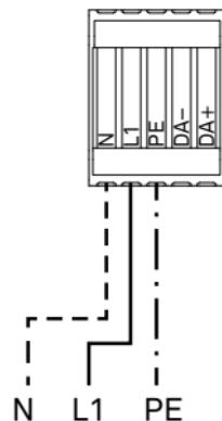
**DE** Anschlussschema für DALI-Betrieb (DT6/DT8)
