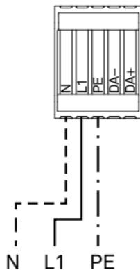
**DE** Anschlussschema für DALI-Betrieb
