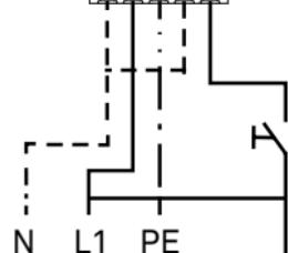
**DE** Anschlussschema mit externem Betriebsgerät **FR** Schéma de câblage avec alimentation externe **IT** Schema di collegamento con alimentatore esterno **EN** Wiring diagram with external operating device
