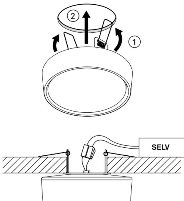
**DE** Anschlusschema mit externem Betriebsgerät **FR** Schéma de câblage avec alimentation externe **IT** Schema di collegamento con alimentatore esterno **EN** Wiring diagram with external operating device
