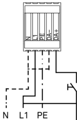
**DE** Anschlussschema für PhasenDim-Betrieb
