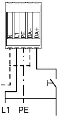
**DE** Anschlussschema für PhasenDim-Betrieb
