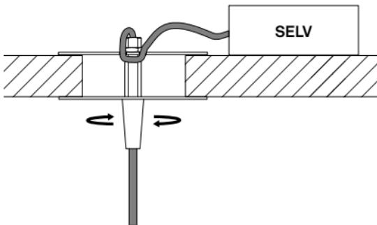
**DE** Anschlusschema mit externem Betriebsgerät **FR** Schéma de câblage avec alimentation externe **IT** Schema di collegamento con alimentatore esterno **EN** Wiring diagram with external operating device
