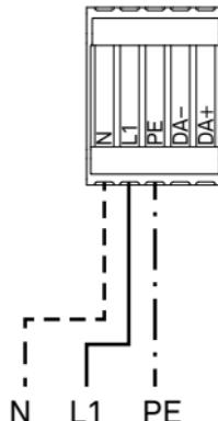
**DE** Anschlussschema für DALI-Betrieb
