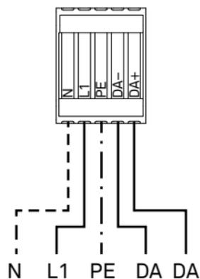
**DE** Anschlussschema für TouchDim-Betrieb
