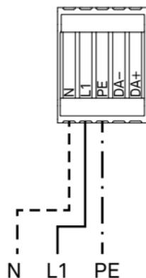
**DE** Anschlussschema für DALI-Betrieb
