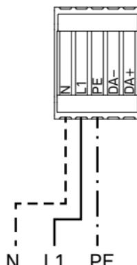
**DE** Anschlussschema für DALI-Betrieb (DT6/DT8)
