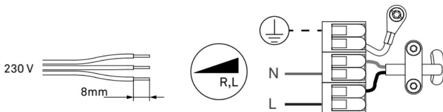
**DE** Anschlussschema mit externem Betriebsgerät **FR** Schéma de câblage avec dispositif de contrôle externe
