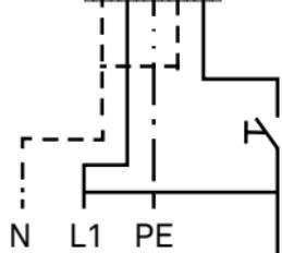
**DE** Anschlussschema für PhasenDim-Betrieb TRIAC
